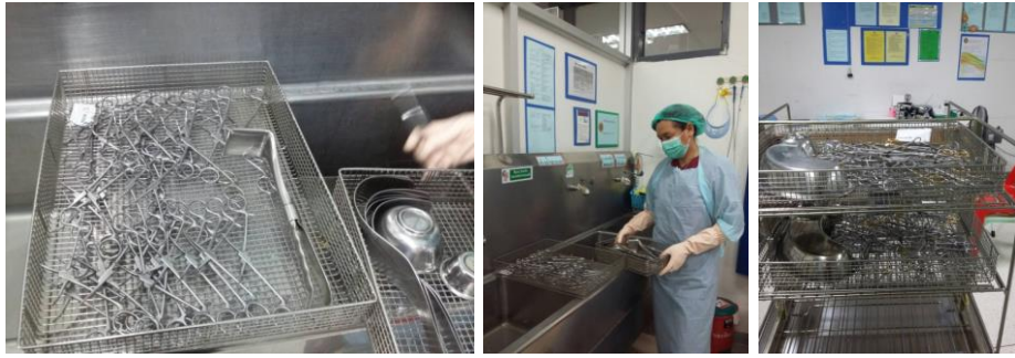
รูปที่ 2.4 Set เครื่องมือที่แยกเป็นชุดแล้ว นำใส่เครื่องล้าง เมื่อล้างเสร็จแล้วทำให้ง่ายต่อการบรรจุหีบห่อ
